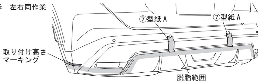
14. 下図を参照し、リヤバンパーの両面テープ貼り付け部に⑧PACプライマーK-500（素地部分）を塗布する。
