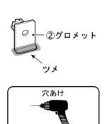
下穴: φ3.0→φ6.0 本穴: φ10.0~φ11.0 4. 下図を参照し、①リヤバンパースポイラーのモール上端とリヤバンパーのセンサーとの隙間及び、タイヤハウス部のモール先端を、指示寸法に合わせてリヤバンパーに仮当てし、下面ブラケットを③タッピングスクリューで仮固定し、(左右各2ヶ所)①リヤバンパースポイラーの上端にマスキングテープを貼り付ける。
