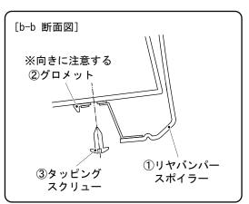
2. 各部の隙や取り付けバランスを確認して、両面テープ離型紙を番号の順に矢印の方向へ剥がし、圧着する。
