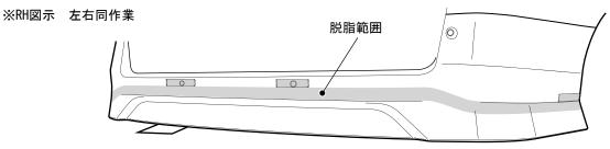
6. 下図を参照し、①リヤバンパースポイラーの両面テープの離型紙を一部めくり、表側に折り返してマスキング テープ等で貼り付ける。
