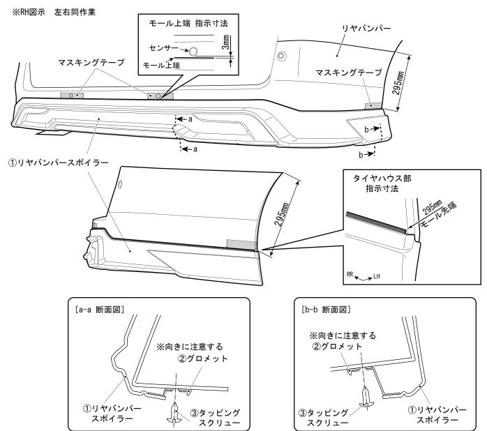
5. ①リヤバンパースポイラーを取り外し、下図の脱脂範囲(幅30mm)をアルコール(IPA)で脱脂する。
