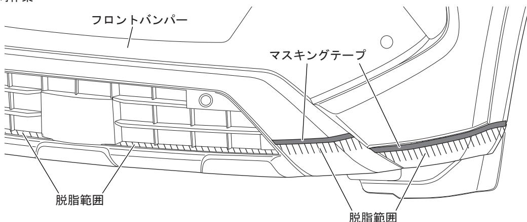
10. 下図を参照し、フロントバンパーの未塗装面に⑥PACプライマー K-500を塗布する。
