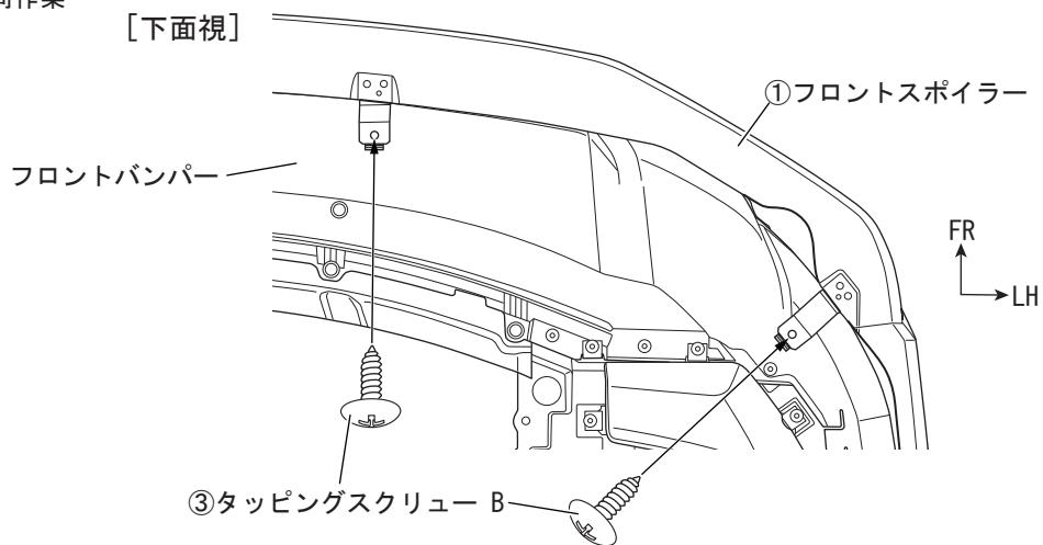
3. 下図を参照し、各部の隙や取り付けバランスを確認して両面テープの離型紙を左右交互に、番号順に矢印の方向へ剥がし、両面テープの面直方向に圧着する。
