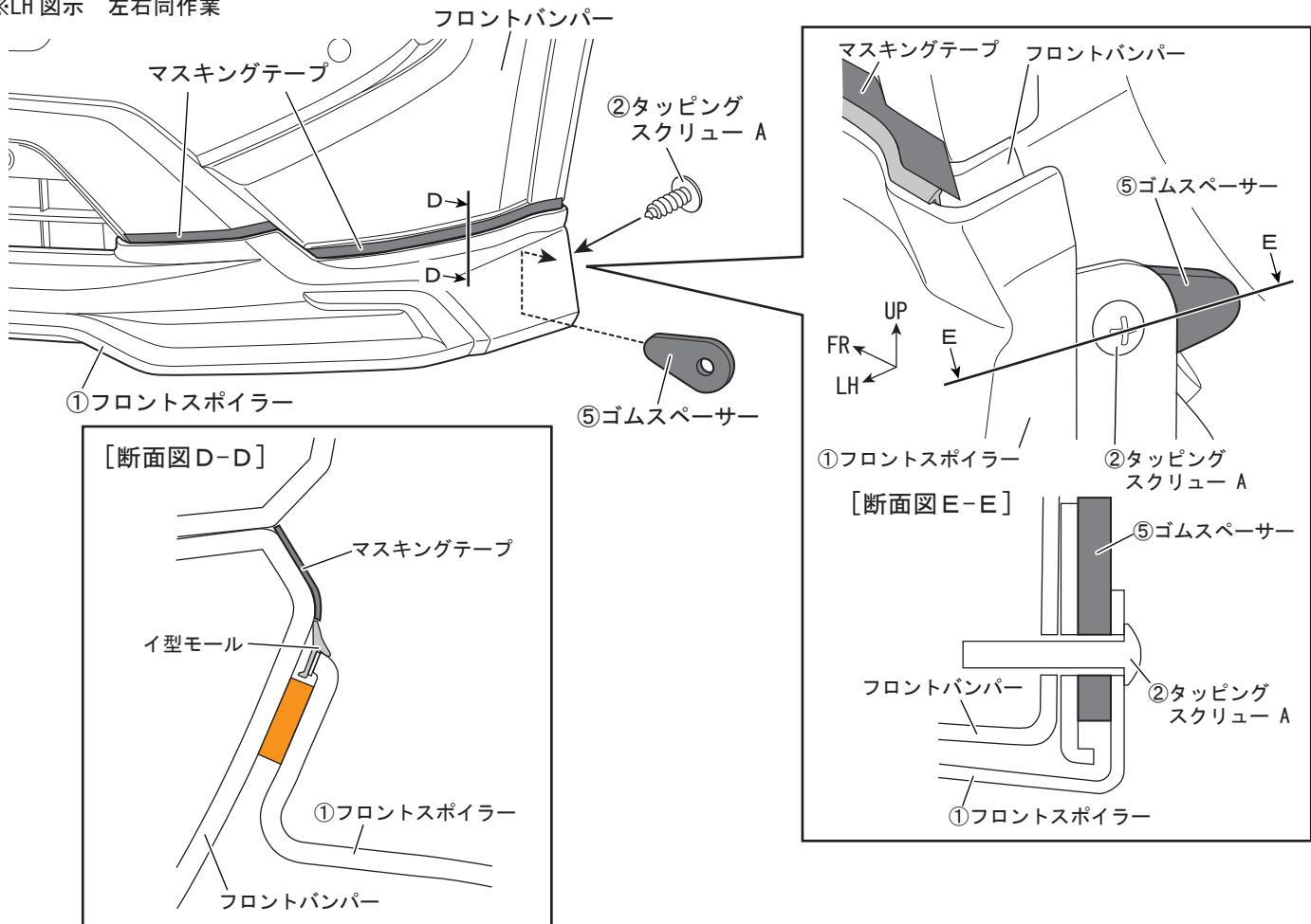
9. 下図を参照し、①フロントspoイラーを取り外してフロントバンパーの両面テープ貼り付け部をアルコール（IPA）で一方向に拭いて脱脂する。
